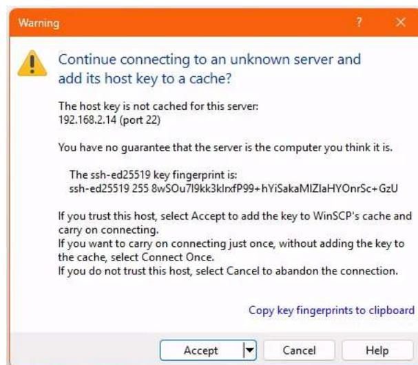
Abbildung 8: Sicherheitsabfrage zum Zertifikat des Geräts für FTP-Zugriff
