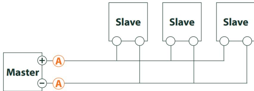
Abbildung 28: Fehlersuche beim M-Bus durch Messung mit Multimeter
