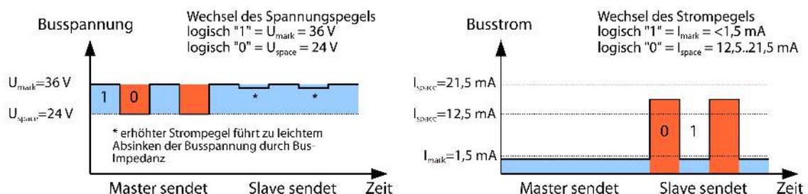
Abbildung 26: Signalisierung beim M-Bus
