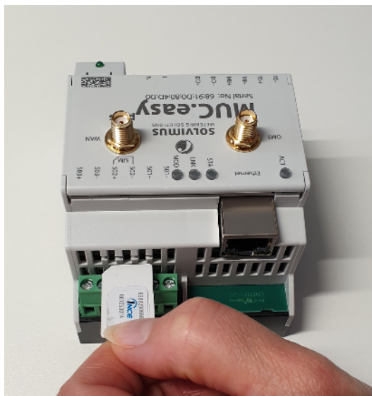
Abbildung 2: Einsetzen der SIM-Karte an einem Gerät mit integriertem Modem
