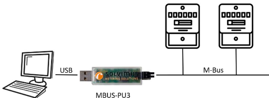
Abbildung 2: Typischer Einsatz des MBUS-PU3
