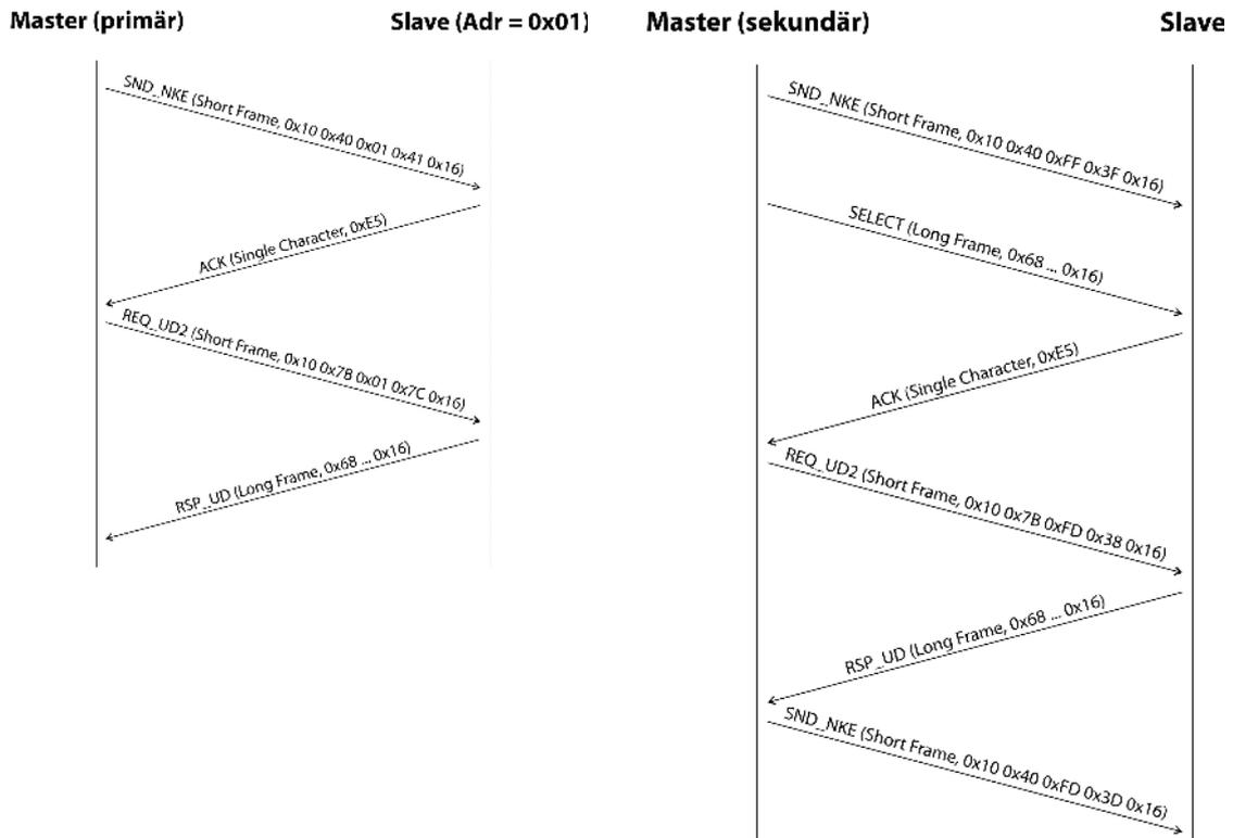
Abbildung 32: Beispiel der Primär- und Sekundäradressierung im Vergleich
