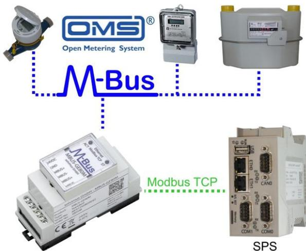
Die Geräte der Familie MBUS-GEM verfügen über eine Ethernet-Schnittstelle, welche Modbus TCP im Slave-Modus unterstützt. Das Leitsystem kann so als Modbus-Master über eine Netzwerkverbindung die Daten der Zähler direkt abrufen, auch dezentral. Diese sind in Modbus-Registern verfügbar.
