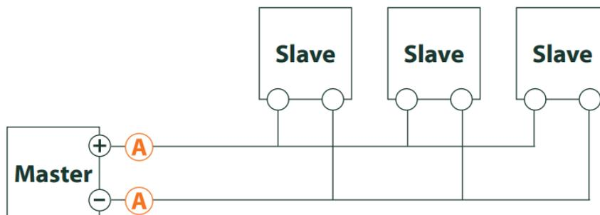
Abbildung 34: Fehlersuche beim M-Bus durch Messung mit Multimeter
