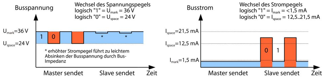
Abbildung 2: Signalisierung beim M-Bus
