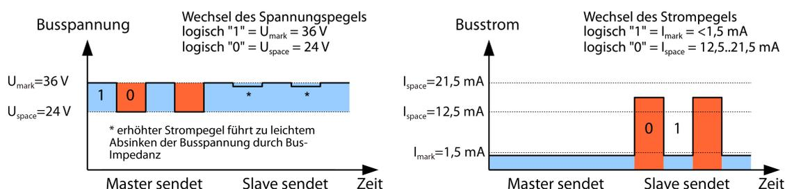
Abbildung 26: Signalisierung beim M-Bus
