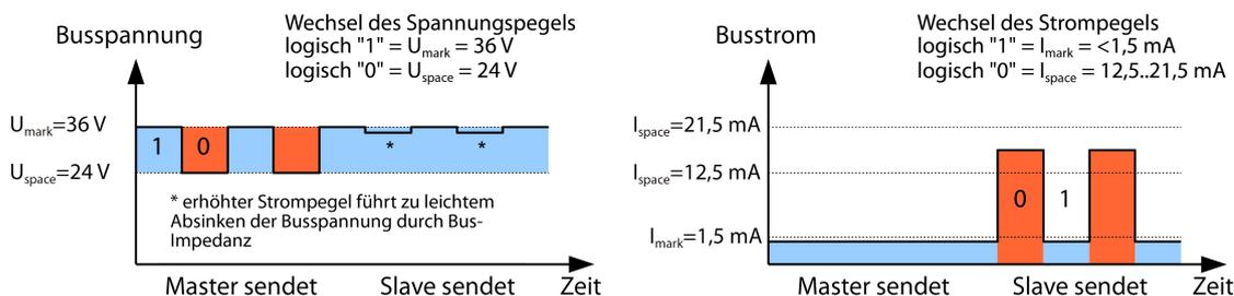
Abbildung 2: Signalisierung beim M-Bus
