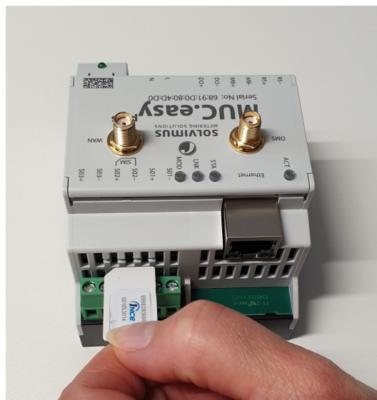
Figure 2 – Insertion de la carte SIM dans un appareil avec modem
