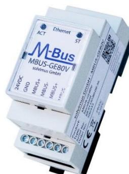
Unsere MBUS-GE20V und MBUS-GE80V sind zwei Pegelwandler, welche die Daten von bis zu 20 bzw. 80 Zählern als Ethernet-Datenpakete transparent zur Verfügung stellen. Die Gegenstelle kann direkt vor Ort, aber auch weit entfernt sein. Ein einfacher TCP-Socket (oder optional ein virtueller COM-Port; wir empfehlen den Treiber der Firma Eltima) wird auf dem Endgerät genutzt, um über Ethernet auf dem M-Bus zu kommunizieren.
