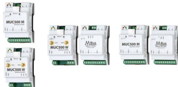
Da in vielen Installationen sowohl drahtgebundene als auch drahtlose Zähler vorhanden sind, verfügt der MUC500 W neben dem Funkempfänger über eine zusätzliche Schnittstelle zum Anschluss eines externen Pegelwandlers für den M-Bus. In Kombination mit dem Pegelwandler MBUS-PS500 kann so beides, M-Bus und wM-Bus ausgelesen werden.
