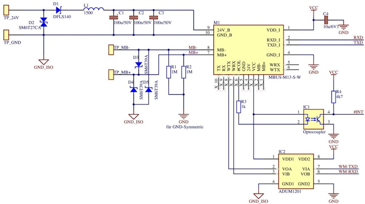
Abbildung 11: Referenzschaltung für MBUS-M13-S-W
