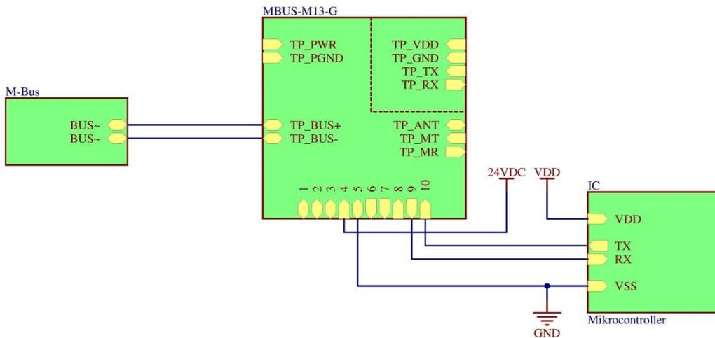
Abbildung 5: Variante MBUS-M13-G mit direkter Logikanbindung
