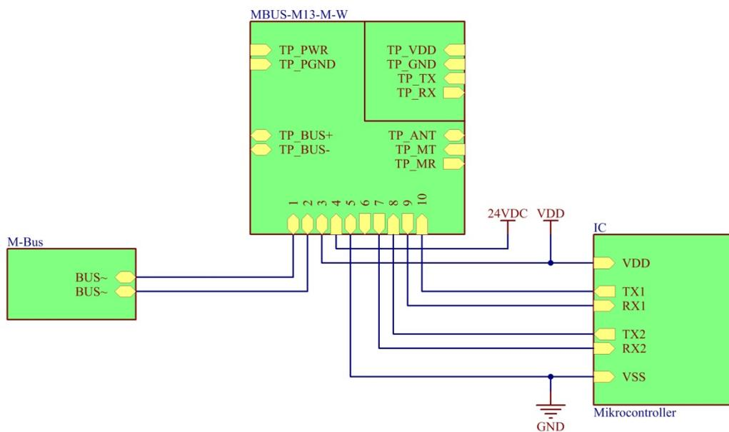
Abbildung 10: Variante MBUS-M13-M-W mit alleiniger Nutzung von X1
