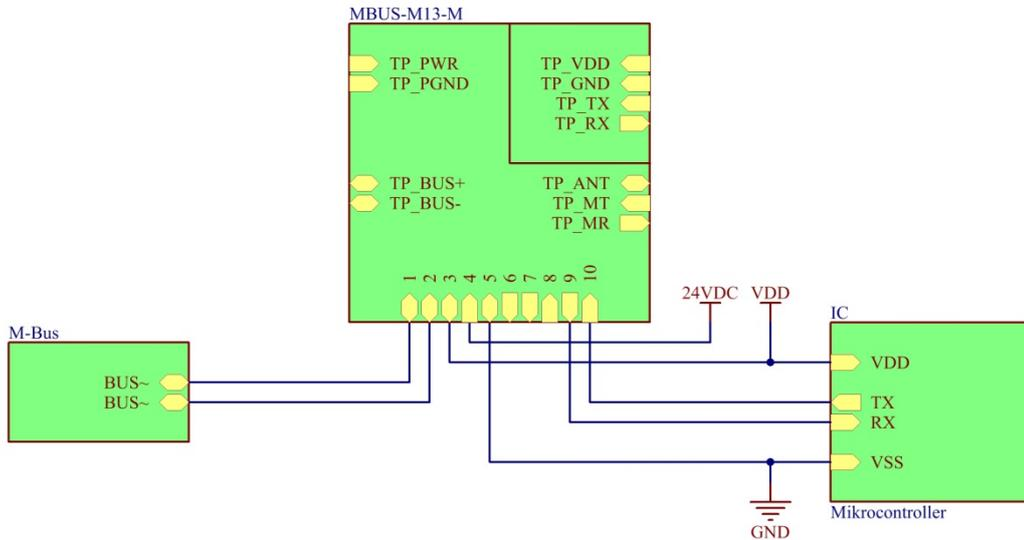
Abbildung 7: Variante MBUS-M13-M mit alleiniger Nutzung von X1
