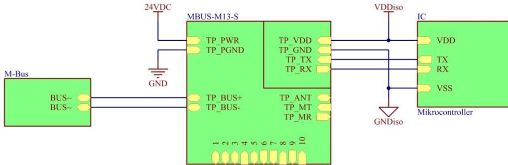
Abbildung 4: Variante MBUS-M13-S mit galvanisch getrennter Logikanbindung
