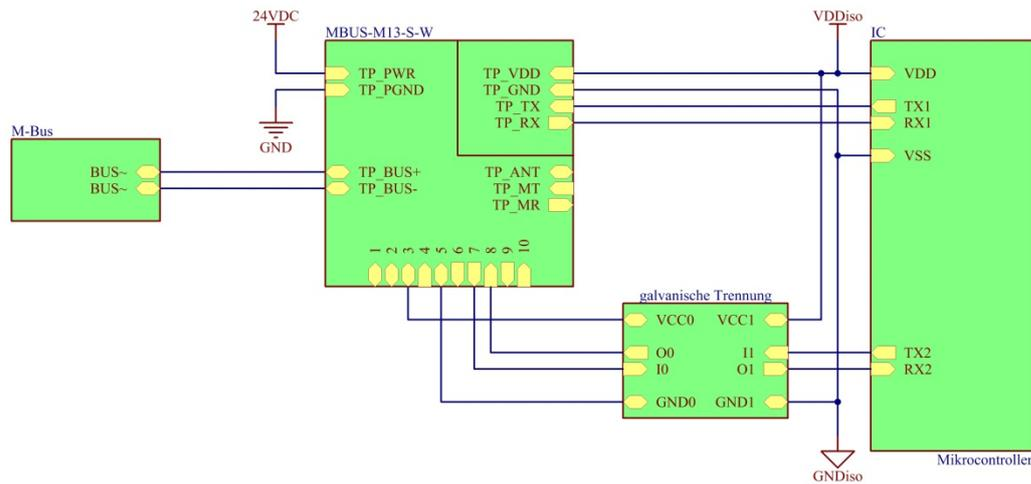
Abbildung 9: Variante MBUS-M13-S-W mit galvanisch getrennter Logikanbindung
